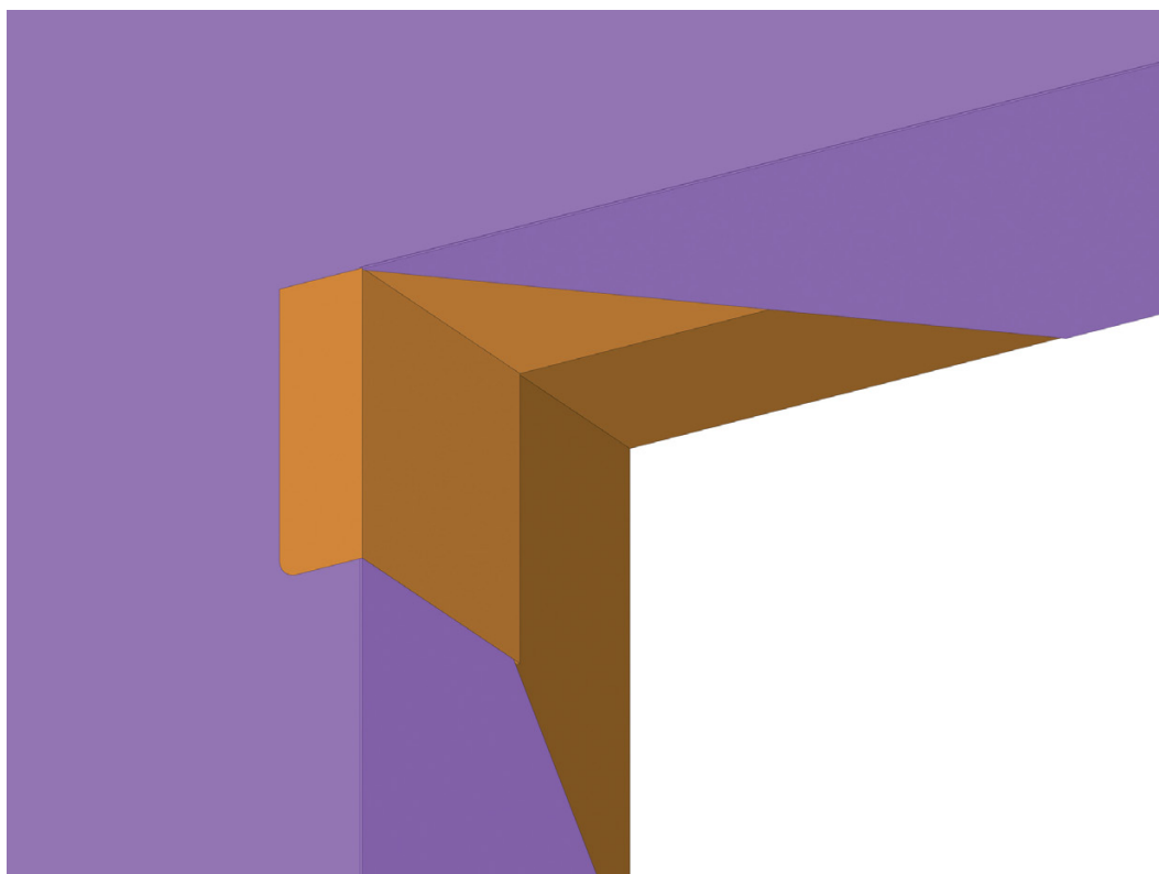
▲ Figure 51 : pose de l'angle préformé en partie haute
