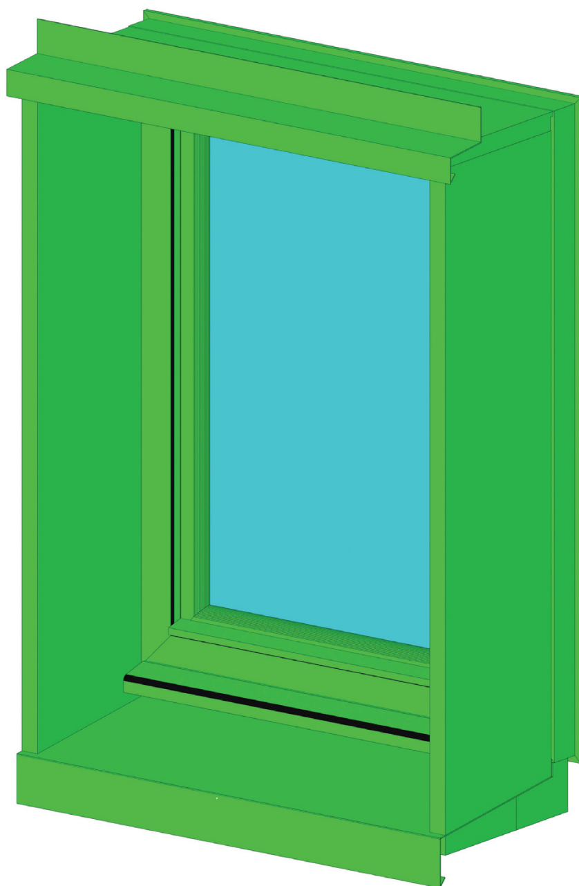
▲ Figure 2 : Fenêtre avec encadrement de baie intégré en usine
