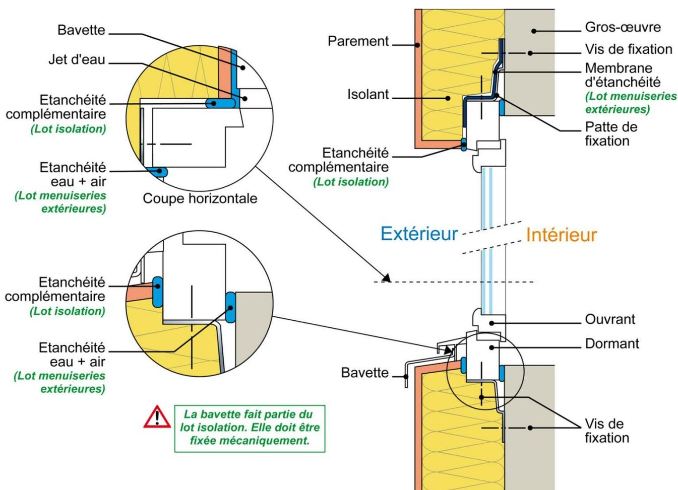
*Exemple de pose de fenêtre en applique extérieure sans pré-cadre avec isolation par l'extérieur de type ETICS (isolant collé sous enduit)*
